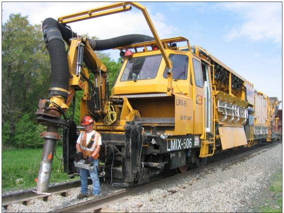
Figure 12. Loram RAILVAC<sup>™</sup> Ballast Vacuum Machine<sup>6</sup>
